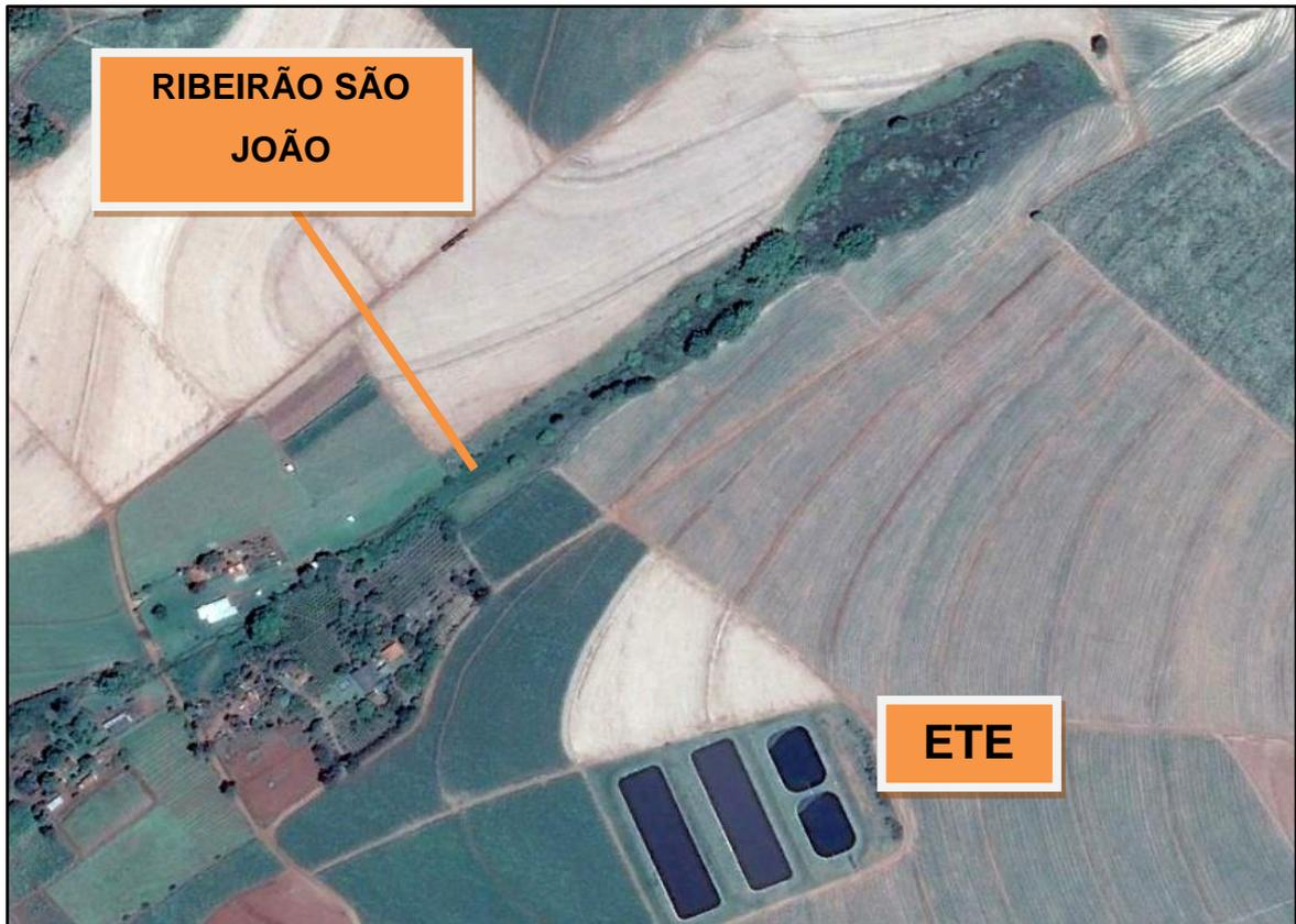
A capacidade de operação da ETE é de 38,80 litros por segundo, com vazão máxima horária de 45,68 litros por segundo. Vale ressaltar que na ETE são feitos os tratamentos necessários do efluente, atendendo aos requisitos previstos nas legislações vigentes.
