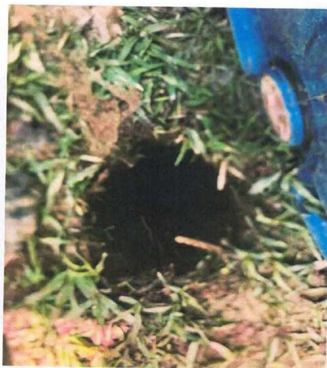
Foto 3.: Perfuração da sondagem
